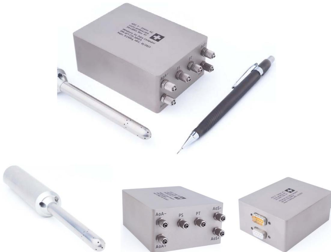
ADS-9五孔压差式空速管迎角侧滑角传感器是一个小型多功能大气数据系统。它测量空速、高度、攻角（AoA）、倾斜角（AoS）和外部空气温度（OAT）。所有飞行擦书数值经过完全校准和空气动力学校正。计算后参数，如气压高度（Hp）、真空速(TAS)、马赫数(Ma)和静温。单独校准的硅基压力传感器能够在-55~+80℃的整个温度范围内，以高达200 Hz的速率测量非常准确和快速的大气数据参数。
