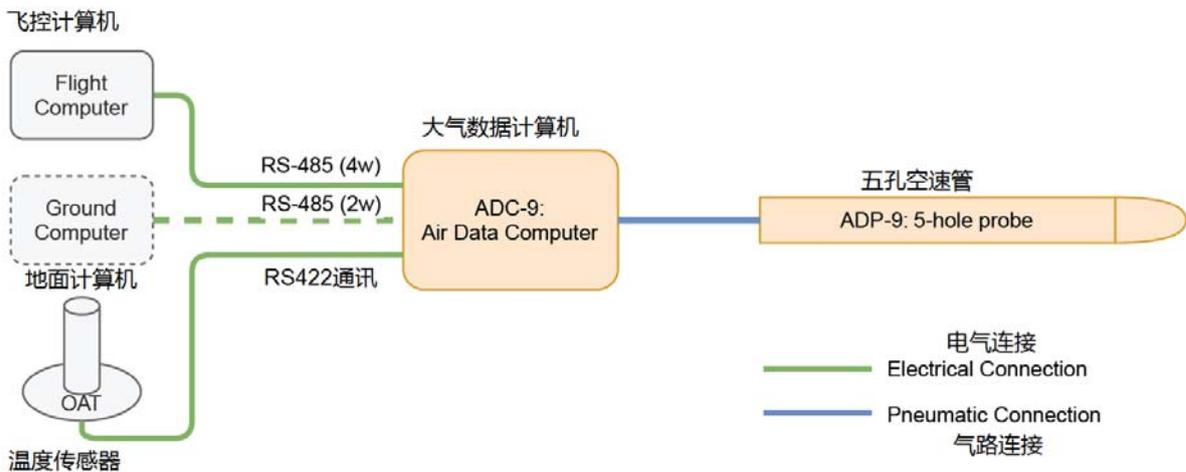
利用ADP-9型五孔空速管探头采集动压、静压、攻角和侧滑角数据。六个气动管路将压力输送至ADC-9大气数据计算机。大气数据测量无摩擦、快速、准确。
