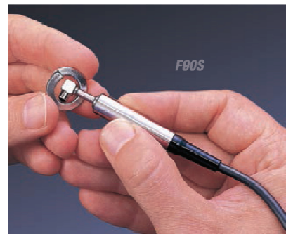
微型探头适用于小零件，以及难以测量的区域
