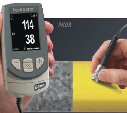
FNDS 探头专门设计为测量镀锌板上的涂层，可同时分别测出锌层和涂层的厚度
