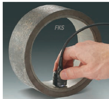
大量程探头系列用于厚的保护层，如环氧树脂、橡胶、防火涂料等
