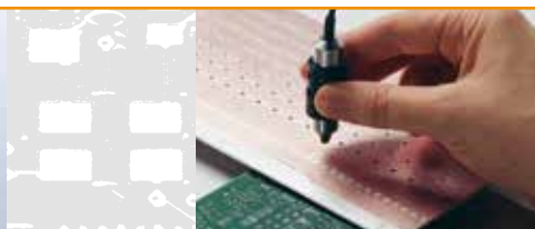
测量印制电路板上的铜箔
