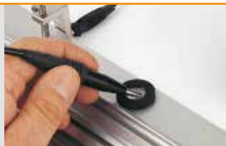
ANOTEST® YMP30-S: 测试阳极氧化层的密封性
