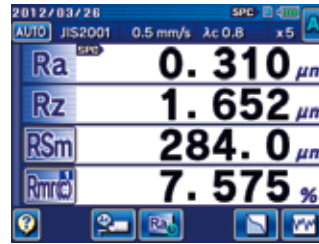
4段显示：显示多个演算结果
