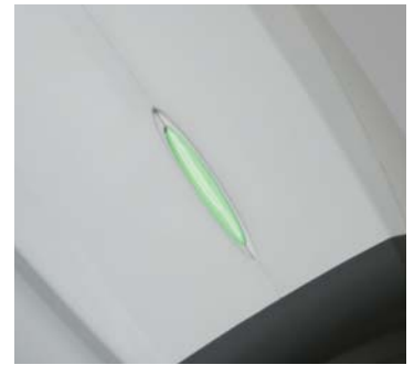
确认放电有无的LED（放电会使红变成绿。）
