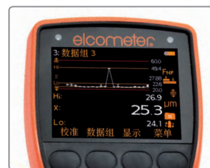
趋势图显示每次扫描的平均，最高，最低厚度读数
