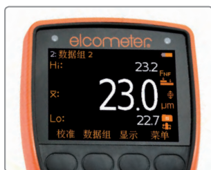
扫描模式*存储整个测试区域内的平均，最高，最低读数
