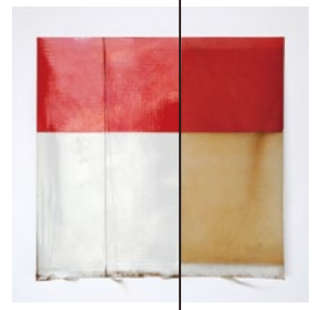
設置:45° 屋外3年 左側:施工済 / 右側:未施工 ※清掃はしていません。
