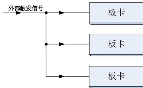
图 4-8-1 外触发同步采集的连接方式
