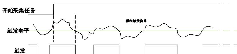
图8-3-5 模拟边沿触发--下降沿触发
