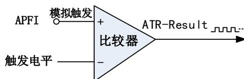
图5-3-4 模拟触发比较器
