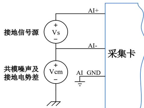
图 4-4-6 接地信号源的差分 (DIFF) 连接
