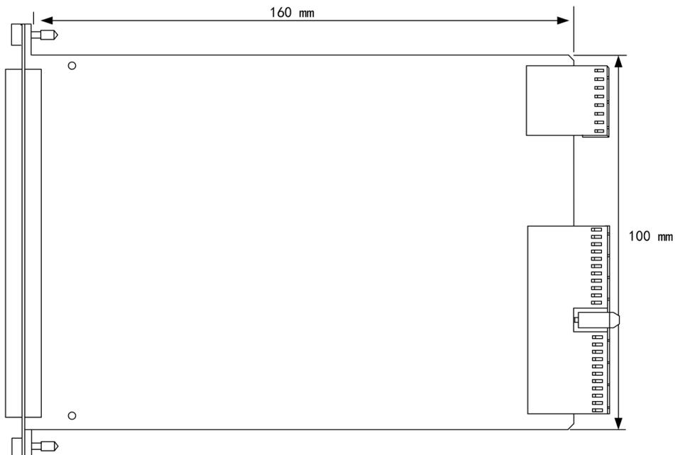
图 3-1-2 PXI2602 尺寸图
