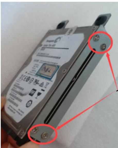
松开固定两块硬盘的八颗螺钉或固定其中一块硬盘的四颗螺钉,取下硬盘,放入需要替换的硬盘,同时锁紧固定硬盘的螺钉
