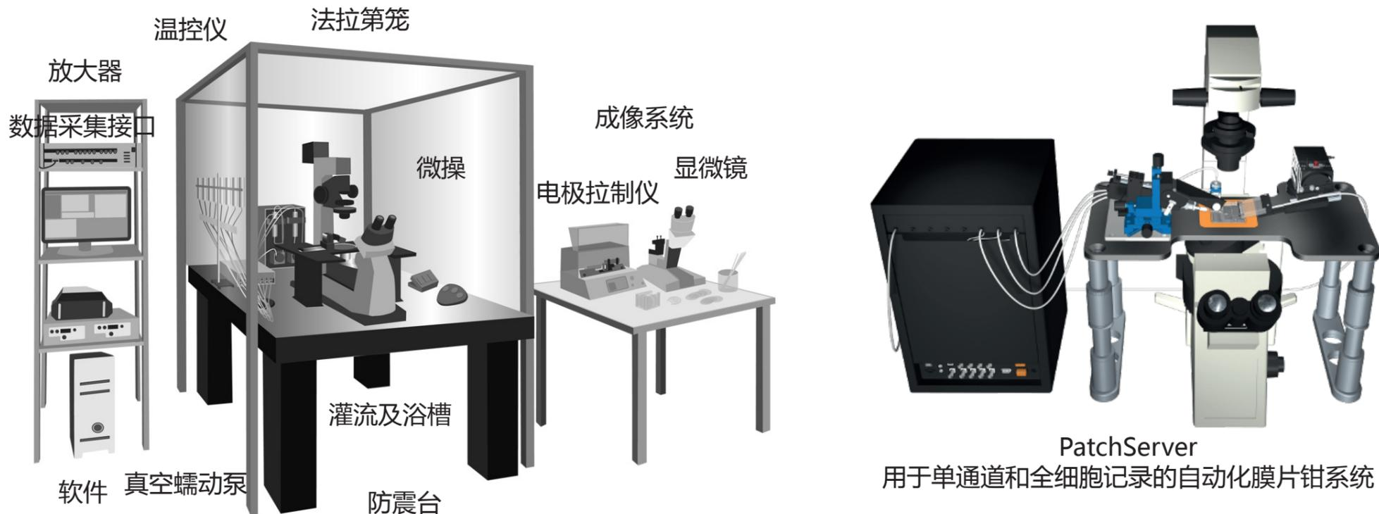
PatchServer 用于单通道和全细胞记录的自动化膜片钳系统
