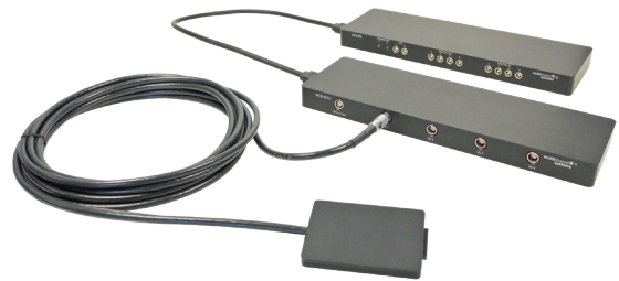
一个由32通道探头、信号采集器和界面板（从前到后）形成的完整的ME2100系统
