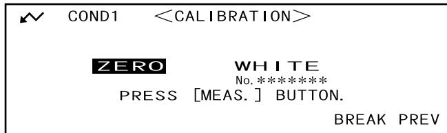
4 直接将样品测量口对着空气。
