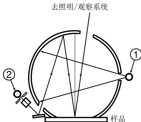
通过上述一次测量和计算就可以同时得到SCI和SCE数据，而不用传统方法中的要求的通过机械方式的切换。
