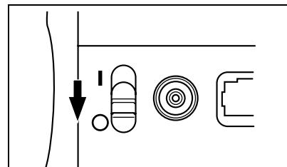
**2** 滑动仪器尾部的盖子打开电池槽。
