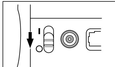
**2** 将变压器的插头和仪器尾部的变压器接口相连接。
