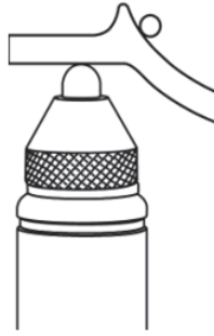
图 4-14 不正确的测量方法：目标滚珠受到阻挡
