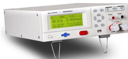
CHT9930A 光伏接地电阻测试仪是本公司专门针对光伏组件接地电阻特性设计的，也称接地连续性测试仪。可编程输出测试电流 DC 10~60A，测试范围达 0.01 $\mu\Omega$ ~600m $\Omega$ ，测试稳定，精度高。具有测试线异常检测功能，有 3 组测试模式，可实现可编程测试和分选。可选配 RS485 接口，通过 MODBUS 通讯协议可以轻松实现仪器组网。符合光伏标准 IEC61730。
