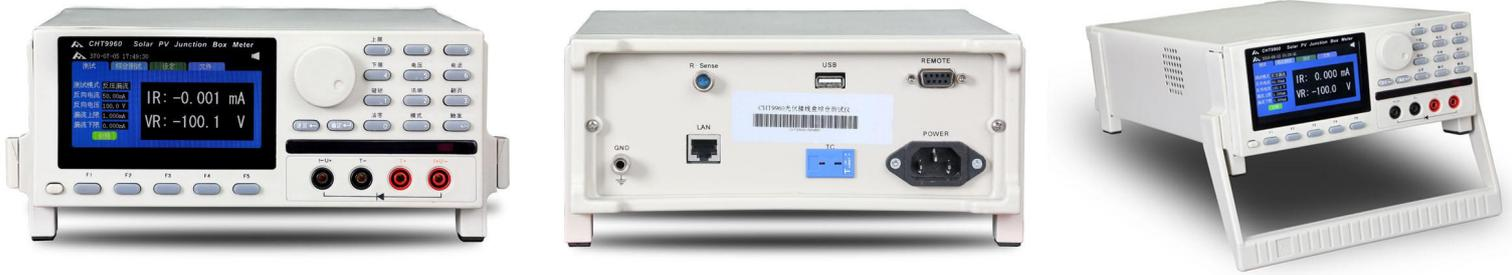
CHT9960 型光伏接线盒综合测试仪是本公司针对光伏接线盒电气特性测试需求而研制的专用测试仪器。可测试接线盒内部二极管的正向导通压降 VF、反向漏电流 IR、反向电压 VR、导通直流电阻 R、以及温度 TC 等参数。能满足 10W~400W 接线盒（2 只~8 只二极管）的测试需求。被广泛应用于接线盒生产厂家的在线测试及组件使用厂家的进货验收。
