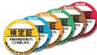
ケツトのライスタは、アフターサービス体制が確立しています。測定器は使用前に動作確認が必要です。特に水分計は見た目だけでは、正しい水分が測定できるかどうか分かりません。このため、ケツトは毎年全国規模でアフターサービスとしてライスタの検定を行い、上のような検定証を貼っています。
