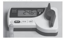
2 選択ボタンは押すたびに、1.FBR(外 国玄米)→2.FWR(外国精米)→…と 順次切り替わりますので、測定したい 試料の項目で止めます。
