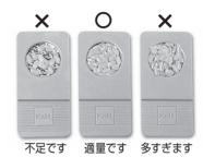
注: 試料皿に採った試料に、未熟な粒(青未熟粒、 死米、異種穀粒等)が混ざっていると、測定 誤差を生じる原因になります。これらの粒 はピンセットで取り除き、その分の整粒を補 充してから測定してください。
