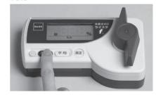
**3** ピンセット付きスプーンを使って、試料を試料皿に、ちょうど**ひとならび**になるように採ります。
