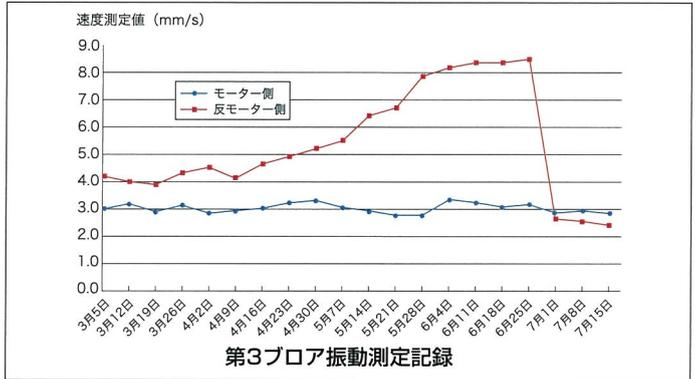
「同種比較」…同種の機械を比較することで振動値の高いもの(異常)を見つけ出す方です。「絶対値評価」…JIS B 0906 (ISO 10816-1)では、機械の規模別に振動速度による振動値評価の基準値が規定されています。
