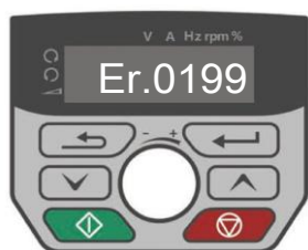
图 4-4 故障告警显示状态
