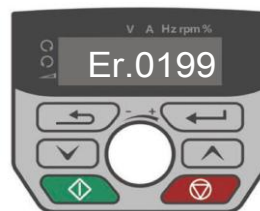
图 4-4 故障告警显示状态
