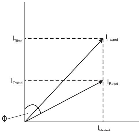
VM\_MOTOR1\_CURRENT\_LIMIT [最大值] 取决于驱动器额定值和电机设置参数。
