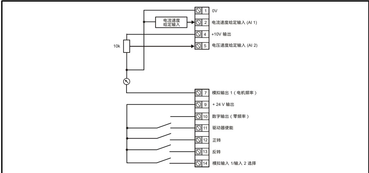
图 6-4 Pr 05 = AV.Pr(2) 电压输入 . 预设
