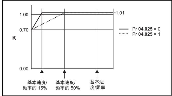
Pr 04.025 的两种设置均用于电机风机的风冷效果随电机速度的降低而降低，但不同速度下风冷效果的降低程度不同的电机。若 Pr 04.025 为 0，则该特性用于风冷效果随低于基本速度 / 频率 15% 的电机速度的降低而降低的电机。若 Pr 04.025 为 1，则该特性用于风冷效果随低于基本速度 / 频率 50% 的电机速度的降低而降低的电机。K1 的最大值为 1.01，因此，高于该特性的基准，电机可以高达 101% 的电流持续运行。
