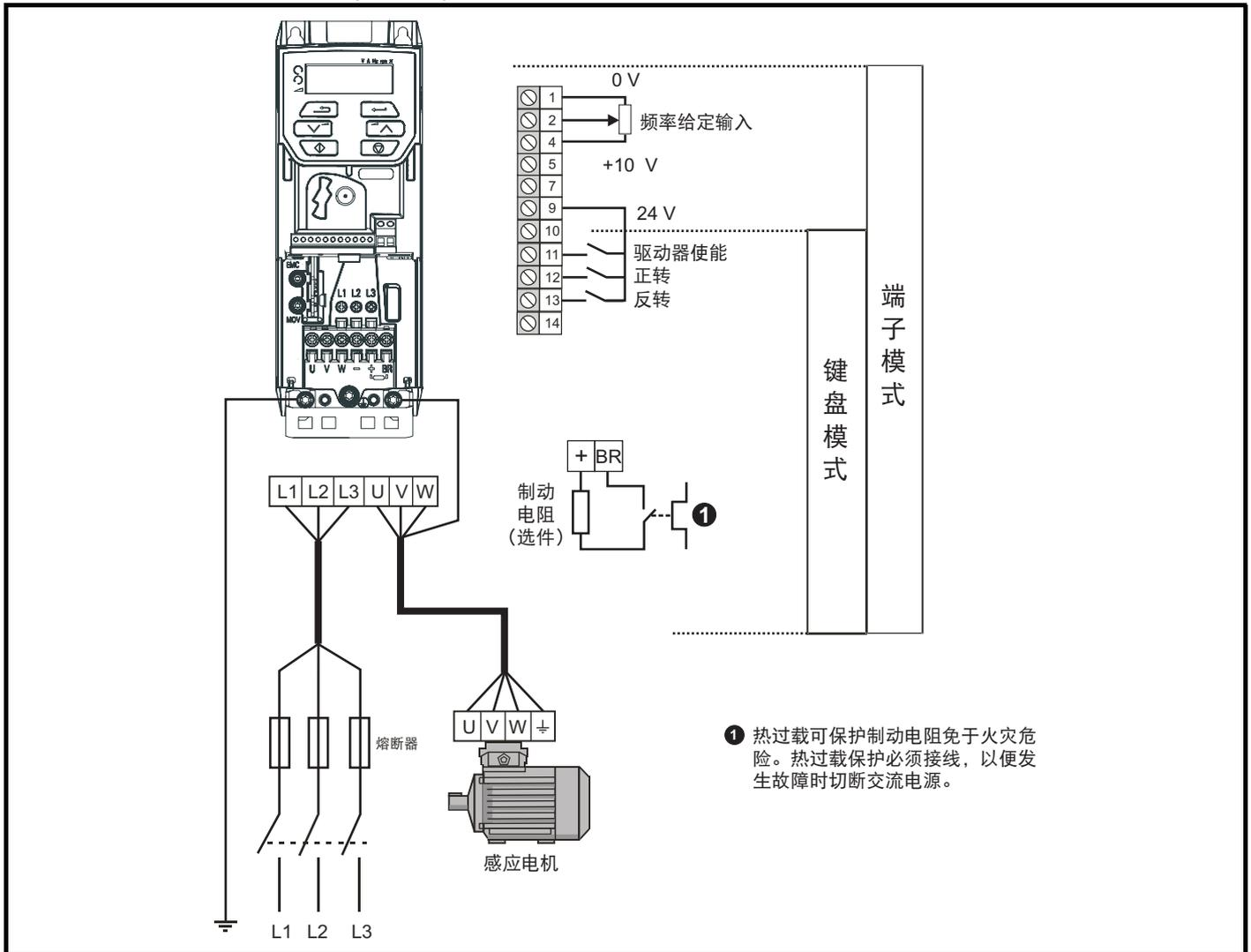
图 7-2 电机以任何模式运行的最小接线 (5 型)
