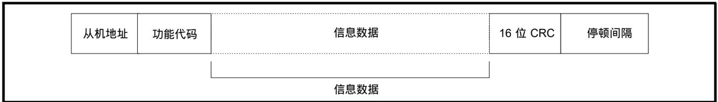
该帧以 3.5 个字符时间的最小停顿期间终止 ( 例如，在 19200 波特时，最小停顿期间为 2 ms )。节点使用终止停顿期间检测帧的结束和开始帧处理。因此，所有帧必须以连续流形式传输，间隙不得超过或等于停顿期间。若插入错误的间隙，接收节点可能会提早开始处理帧，在这种情况下，CRC 将失败，帧将被丢弃。
