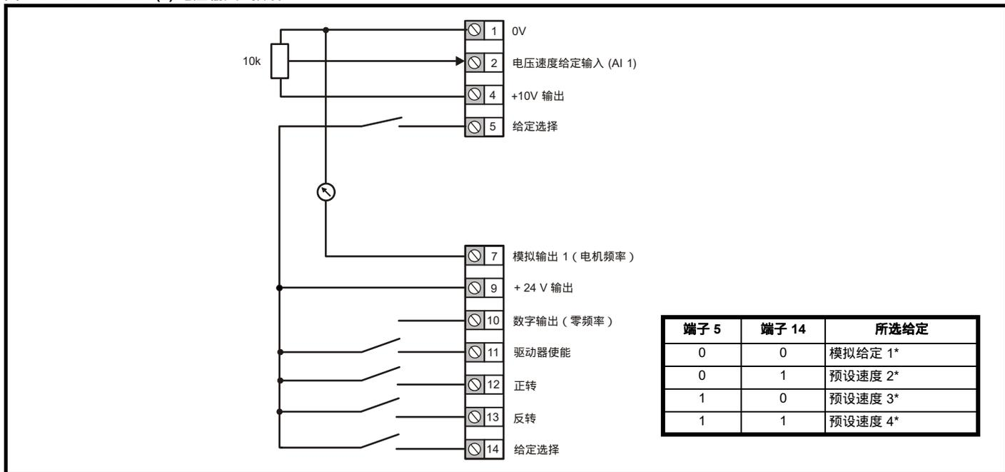
图 6-5 Pr 05 = AI.Pr(3) 电流输入 . 预设
