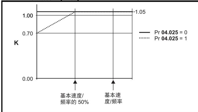
若 Pr 04.025 为 0，则该特性用于可在整个速度范围内的额定电流下运行的电机。带该种特性的感应电机通常有强制风冷装置。若 Pr 04.025 为 1，则该特性用于电机风机的风冷效果随低于基本速度 / 频率 50% 的电机速度的降低而降低的电机。K1 的最大值为 1.05，因此，高于该特性的基准，电机可以高达 105% 的电流持续运行。
