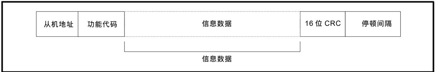
该帧以 3.5 个字符时间的最小停顿期间终止 (例如, 在 19200 波特时, 最小停顿期间为 2 ms)。节点使用终止停顿期间检测帧的结束和开始帧处理。因此, 所有帧必须以连续流形式传输, 间隙不得超过或等于停顿期间。若插入错误的间隙, 接收节点可能会提早开始处理帧, 在这种情况下, CRC 将失败, 帧将被丢弃。
