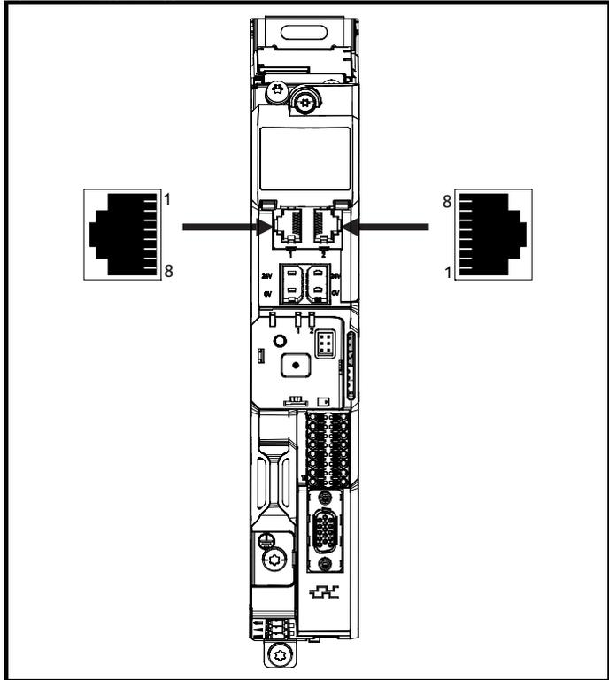
M750 提供两个 RJ45 接线，并带有以太网开关，以方便网络建立。
