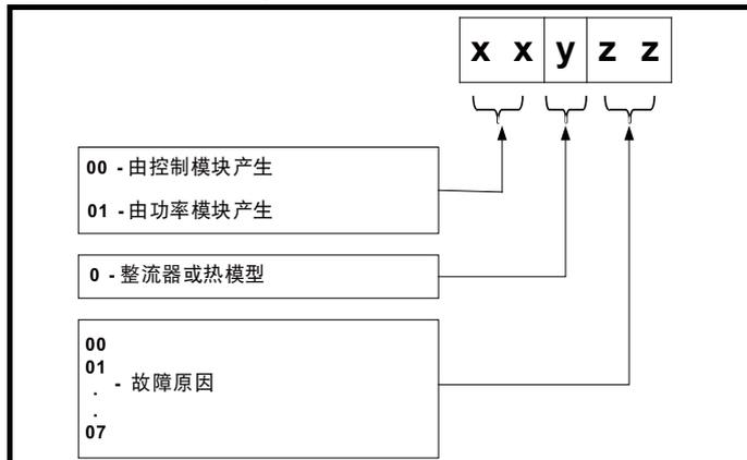
例如：若驱动器发生故障，显示器的下行显示“Oht Control.2”，通过下面的表 13-3，该故障可解释为：检测到过热；故障由控制模块故障产生，控制板热敏电阻 2 过热。更多关于单个子故障的信息，请参阅表 13-4 中的诊断列。
