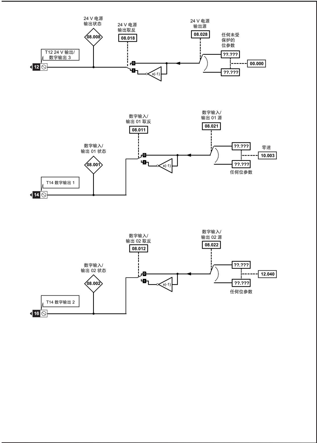
图 12-20 菜单 8 远程键盘 RTC 键逻辑图
