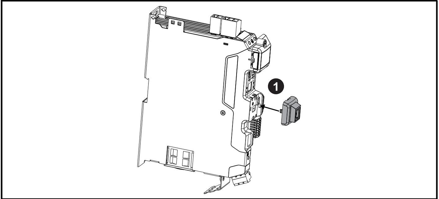
1. 将 KI 远程键盘适配器与显示器外壳对准，向下推入直到其卡到位。
