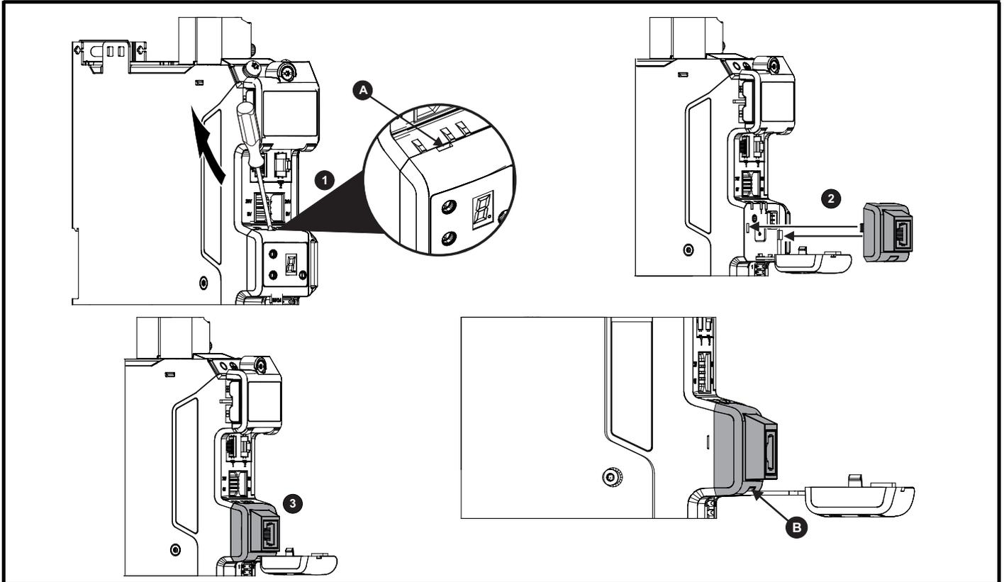
1. 将显示器拧开并从前盖板拉出。系绳保持显示器与驱动器相连，不得拆除。可能需要一把小型端子螺丝刀拧开显示器。驱动器上的插槽即用于此目的 (A)。
