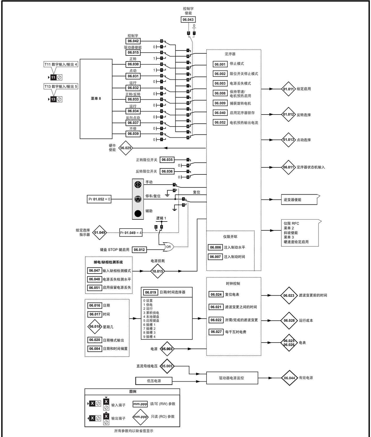
图 12-16 菜单 6 逻辑图：欠压和电源控制
