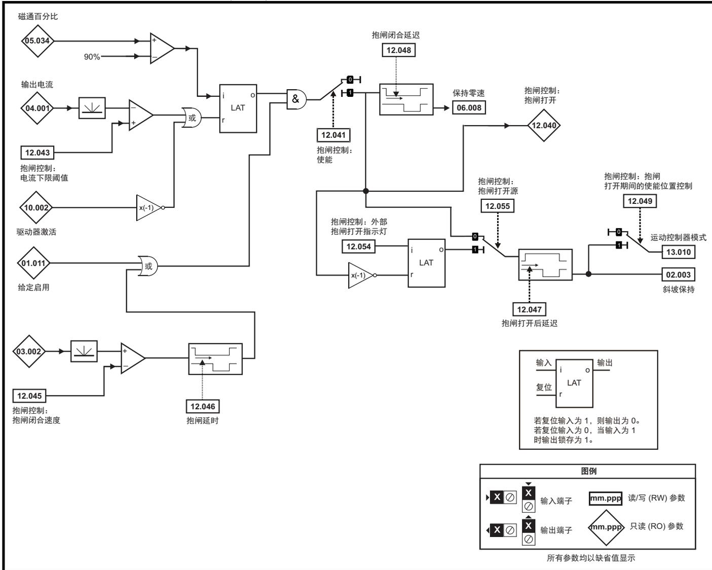
图 12-30 具有位置反馈抱闸程序的 RFC-A
