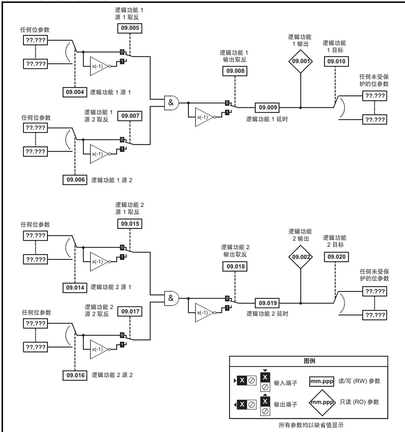
图 12-22 菜单 9 逻辑图：电动电位器和二进制和
