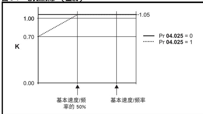
若 Pr 04.025 为 0，则该特性用于可在整个速度范围内的额定电流下运行的电机。带该种特征的感应电机通常有强制风冷装置。若 Pr 04.025 为 1，则该特征用于电机风扇的风冷效果随低于基本速度 / 频率 50 % 的电机速度的降低而降低的电机。K1 的最大值为 1.05，因此，高于该特征的基准，电机可以高达 105 % 的电流持续运行。
