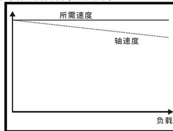
为了防止如上所示的速度降低，应启用滑差补偿。若要启用补偿滑差，必须将 Pr 05.027 设为 1（这是默认设置），并将电机额定速度输入 Pr 00.045 (Pr 05.008) 中。
