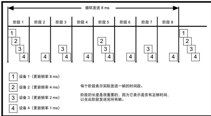
Profinet 循环传输实际上是最慢的更新速率（在本示例中为 8 ms），此相位持续时间实际上是最快的更新速率（在本示例中为 1 ms）。
