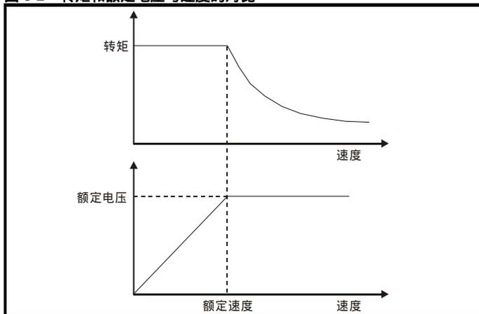
必须小心操作，确保基速上的可用转矩充足，以保证应用的顺利运行。RFC-A 模式下的自动调谐过程中发现的饱和断点参数（Pr 05.029、Pr 05.030、Pr 05.062 和 Pr 05.063）可确保特定电机的磁化电流按正确的比例减少。（在开环模式下，励磁电流不会被主动控制）。
