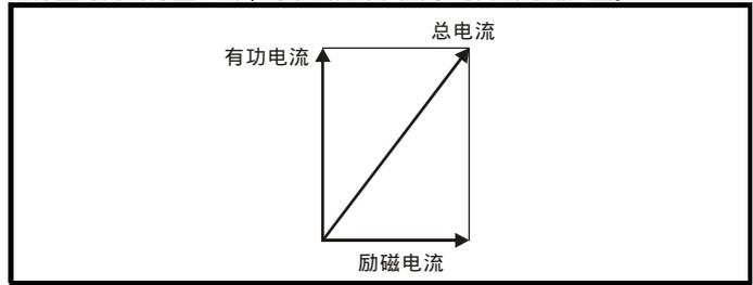
有功电流为转矩产生电流，无功电流为磁化电流或磁通产生电流。
