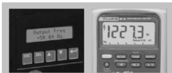
图 2. 未使用低通滤波器时测得的输出频率 (马达速率)
