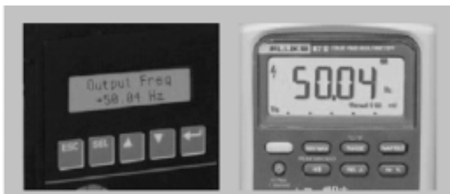
图 1. 使用低通滤波器时测得的输出频率 (马达速率)
