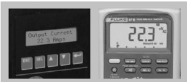
图 2. 使用低通滤波器时测得的输出电流读数。
