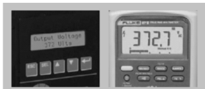
图 2. 使用了低通滤波器的输出电压读数。
