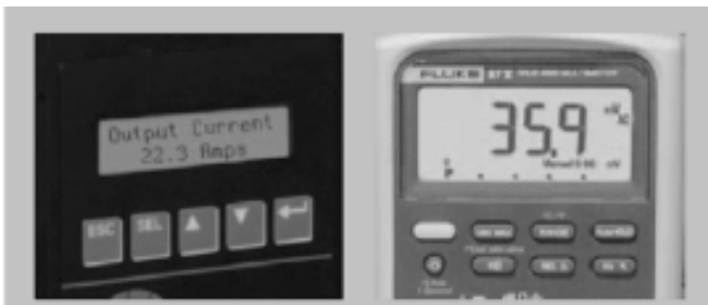
图 1. 未使用低通滤波器时测得的输出电流读数。
