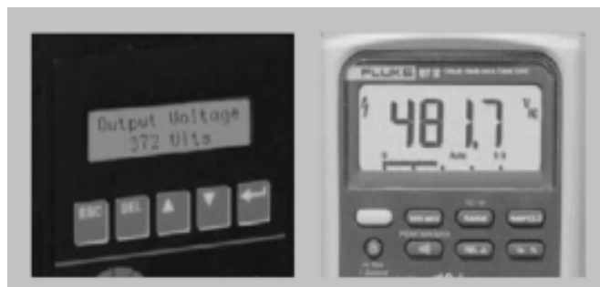
图 1. 未使用低通滤波器的输出电压读数。
