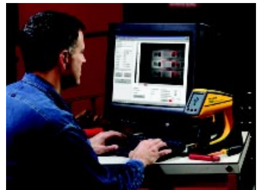
下载数据和热像图到 InsideIR 软件中，轻松进行分析和建立报表
