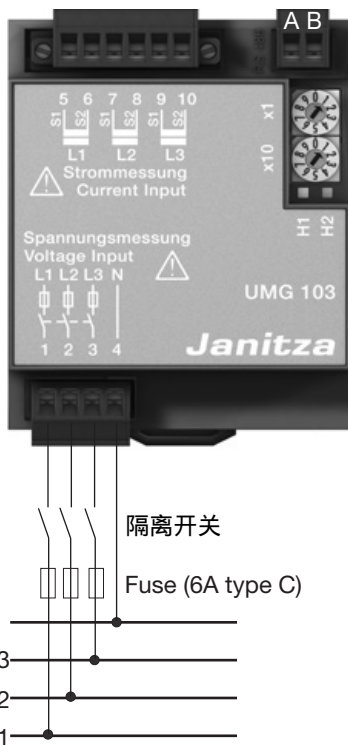
图16.1连接实例:通过隔离器和熔断器测量电压。
