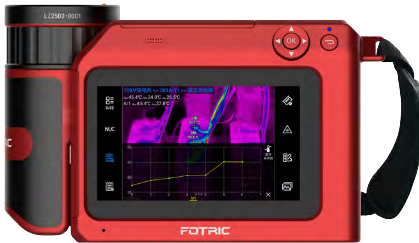
本机现场显示设备历史温升曲线
