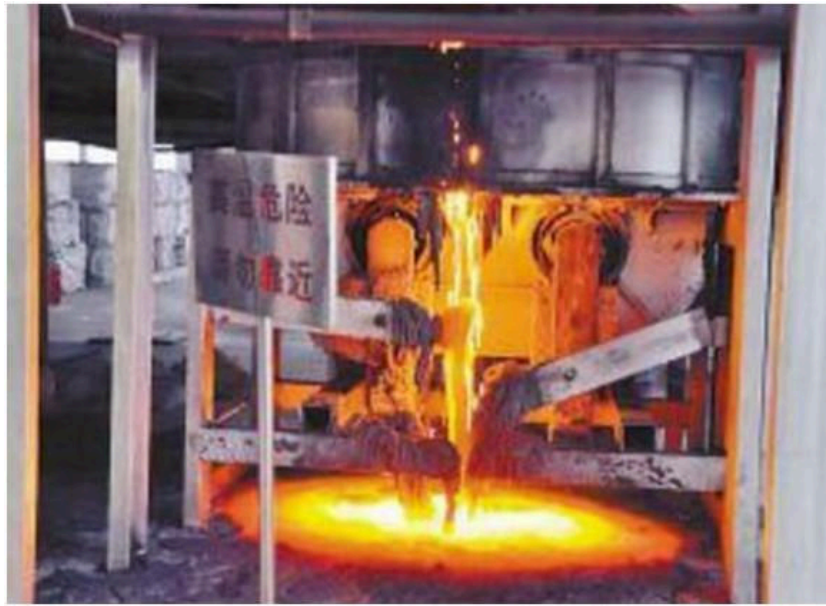
图 3 某钢企穿包事故现场图
