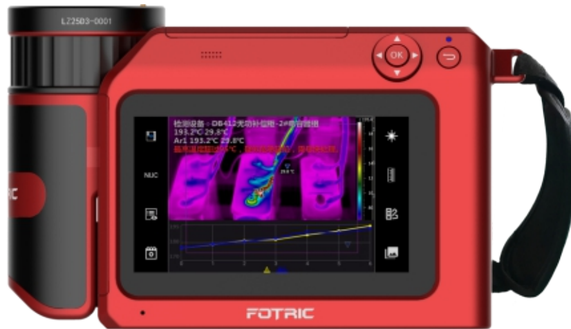
本机现场显示设备历史温升曲线
