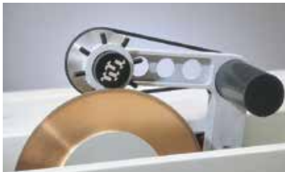
11-2181 可转动台钳夹具，用于切割难切材料。
