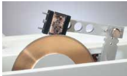
11-2484 玻璃片夹具，可固定岩相样品进行再切割。
