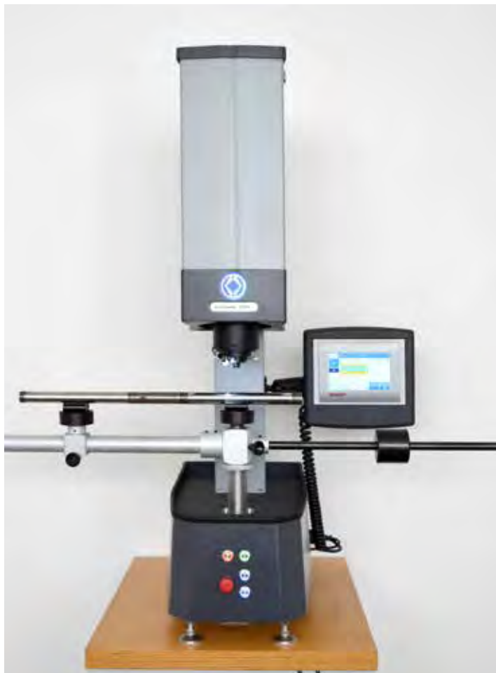
VariRest 样品支架 适用于尺寸 1 的 RH2150 硬度计, 不附带双圆柱试台 编号: WHVRETEX
