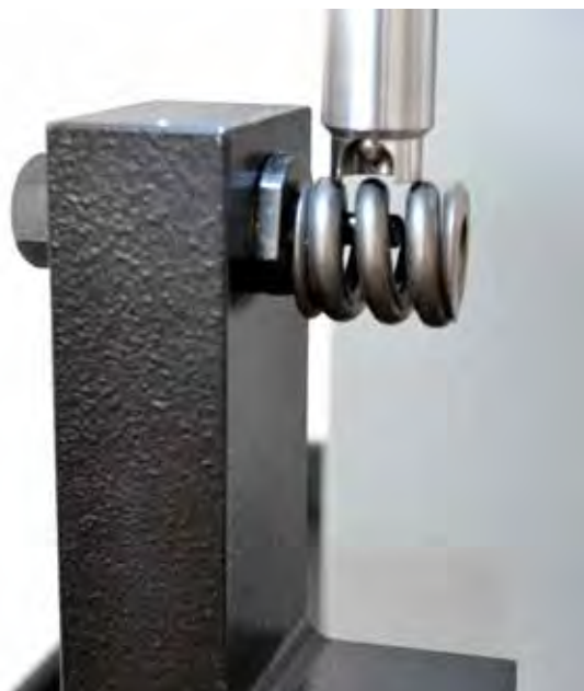
带有 0.25in[6,35mm] 心轴的鹅颈试台 用带有不同直径心轴的鹅颈试台测试弹簧或壳体 编号: 900007803
