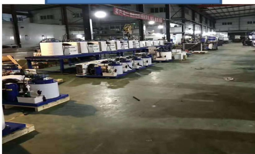
制冰机调试产线
