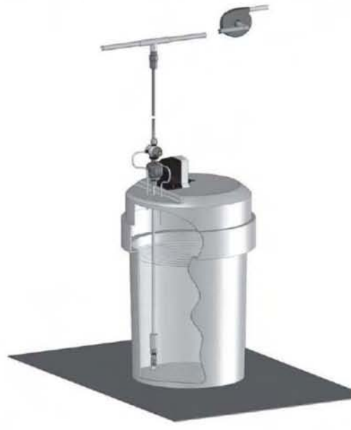
当向离心泵入库投加时（真空）使用 4FV 防虹吸
