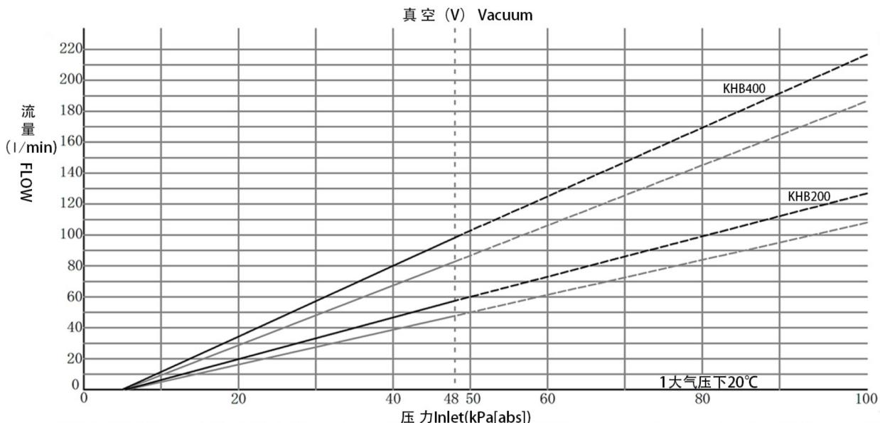
※ 性能实测数据表示带过滤器的数据。配管连接时,由于有阻力、
