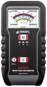
Tramex CME5混凝土含水量测定仪是一种用于混凝土地板和混凝土板的无损模拟湿度计，使用重量测试作为基线，提供即时和精确的水分含量定量测量。CME5还提供了混凝土和其他胶结基材的碳化物方法等效读数，以及ASTM F2659的比较读数。
