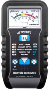
Tramex ME5含水量测定仪是一种双深度、非破坏性湿度计，用于即时水分测量和评估。深穿透深度可达30mm (1.25")，浅层深度可达10mm (0.40")。5个测量范围：木材和木料 / 浅深度 / 干墙和屋顶 / 石膏和瓷砖 / 砖石，这是在建筑围护结构中的各种材料中进行测试的理想选择。
