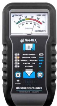
Tramex含水量测定仪ME5是一种双深度、无损湿度计，用于即时水分测量和评估。深度渗透达30mm (1.25 ") 和浅层深度渗透高达10mm (0.40" ) 5个灵敏度范围：木料和木材/浅层/干墙和屋顶/石膏板/砖头，这使得水分遭遇非常适合在建筑围护结构中的各种材料中进行测试。
