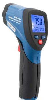
IRT2是一种手持式、双激光器、非接触式红外温度计，具有12: 1的距离与光点比和可听和可见的高/低设定报警。它用于测量和显示-50°C至650°C (-58°F至1202°F)范围内的表面温度，其精度约为1至1.5% (详见规范)。IRT2具有快速响应时间 (0.15秒)，采用9V电池供电，符合II级英国/欧盟激光安全标准EN60285。
