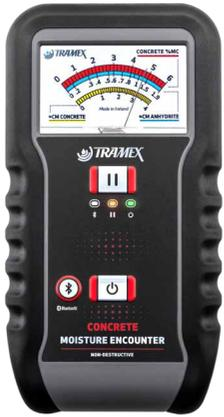
Tramex CME5混凝土含水量测定仪是一款用于混凝土地板和楼板的非破坏性模拟湿度计，以重量法测试为基准，提供即时和精确的水分含量定量测量。CME5混凝土含水量测定仪还提供混凝土和其他水泥基材的碳化物方法等效读数以及根据 ASTM F2659 的比较读数。
