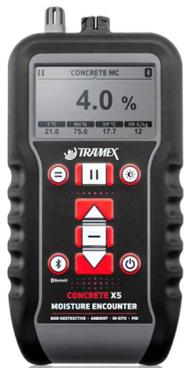
Tramex CMEX5 混凝土含水量测定仪是一种用于混凝土地板和楼板的非破坏性数字多水分仪，使用重量测试作为基准，提供即时和精确的水分含量定量测量。CMEX5 混凝土含水量测定仪还提供混凝土和其他胶结基材的碳化物方法等效读数以及根据 ASTM F2659 的比较读数。结合用于根据 ASTM F2170 进行的可选 Hygro-i2® 相对湿度探头测试和重型针式木探头的插入端口，该湿度计转变为适合地板专业人士的理想的多合一仪器。
