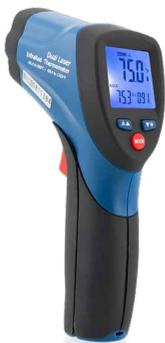
IRT2是一种手持式、双激光器、非接触式红外测温仪，具有12: 1的距离与光点比和可听和可见的高/低设定点报警。它用于测量和显示-50°C 至650°C 范围内的表面温度，其精度约为1至1.5% (详见规范)。IRT2具有快速响应时间 (0.15秒)，采用9V电池供电，符合II级英国/欧盟激光安全标准EN60285。
