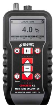
Tramex CMEX5 混凝土含水量测定仪是一种用于混凝土地板和楼板的非破坏性数字多水分仪，使用重量测试作为基准，提供即时和精确的水分含量定量测量。CMEX5 混凝土含水量测定仪还提供混凝土和其他胶结基材的碳化物方法等效读数以及根据 ASTM F2659 的比较读数。结合用于根据 ASTM F2170 进行的可选 Hygro-i2® 相对湿度探头测试和重型针式木探头的插入端口，该湿度计转变为适合地板专业人士的理想的多合一仪器。
