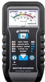
Tramex ME5含水量测定仪是一款双深度、无损水分仪，用于即时水分测量和评估。深深度穿透力可达30毫米，浅深度穿透力可达10毫米。具有5个灵敏度范围：木材和木料 / 浅深度 / 干墙和屋顶 / 石膏和瓷砖 / 砖石，使含水量测定仪非常适合在建筑围护结构中的各种材料中进行测试。
