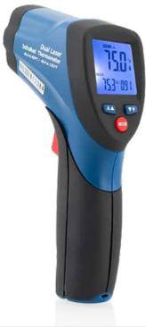
IRT2是一种手持式、双激光器、非接触式红外测温仪，具有12: 1的距离与光点比和可听和可见的高/低设定点报警。它用于测量和显示-50°C 至650°C 范围内的表面温度，其精度约为1至1.5% (详见规范)。IRT2具有快速响应时间 (0.15秒)，采用9V电池供电，符合II级英国/欧盟激光安全标准EN60285。
