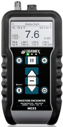
Tramex MEX5 含水量测定仪是一款数字双深度、无损水分计，适用于木材和各种建筑材料，如干墙、石膏、瓷砖和砖石。MEX5 含水量测定仪具有用于环境条件和湿度值的内置湿度计、红外表面温度计，还包括用于现场平衡RH读数的外部原位RH探头，以及用于木材、干墙和WME读数的针式探头。
