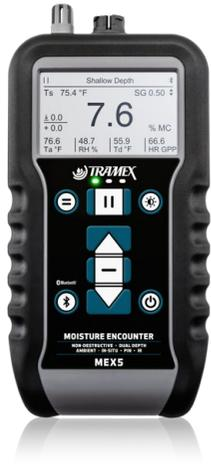
Tramex MEX5含水量测定仪是一款数字双深度、无损水分计，适用于木材和各种建筑材料，如干墙、石膏、瓷砖和砖石。含水量测定仪MEX5具有用于环境条件和湿度值的内置湿度计、红外表面温度计，还包括用于现场平衡RH读数的外部原位RH探头，以及用于木材、干墙和WME读数的针式探头。水分测试结果可以可视化和地理标记的Tramex App应用程序，并转化为水分地图，报告和图表共享。
