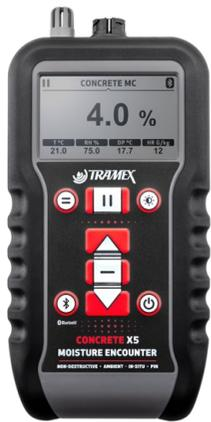
Tramex CMEX5混凝土含水率测定仪是一种用于混凝土地板和混凝土板的无损数字万用湿度计，提供即时和精确的定量测量水分含量。根据ASTM F2659，CMEX5还提供了混凝土和其他水泥基质的碳化物方法等效读数，以及比较读数。根据ASTM F2170的可选Hygro-i2®相对湿度探头测试的插件端口和重型针式木材探针，该湿度计转变为地板专业人士的理想一体化仪器。
