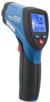
IRT2是一种手持式、双激光器、非接触式红外温度计，具有12: 1的距离与光点比和可听和可见的高/低设定报警。它用于测量和显示-50°C至650°C (-58°F至1202°F)范围内的表面温度，其精度约为1至1.5% (详见规范)。IRT2具有快速响应时间 (0.15秒)，采用9V电池供电，符合II级英国/欧盟激光安全标准EN60285。
