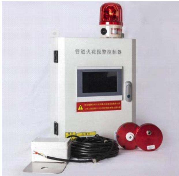
报警控制器具备自动控制检测各部件的工作状态,探测到火星、火焰等危险时立即输出熄灭启动信号,同时启动声光报警器,可通过触摸屏显示探测单元和熄灭单元的工作状态。
