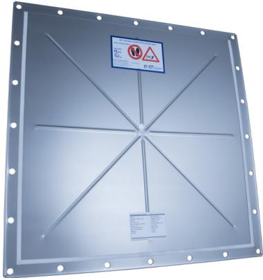
如果负压不大于额定破裂压力的 60%，则安装圆顶形泄压口不会有额外的好处。对于这种应用场景，KE 型泄压口可以替代圆顶 GE。与圆顶型相比，KE 型持久耐用，并具有空气动力学优势（例如用于旋风分离器）。KE 型的标准设计特征包括压力峰值阻尼、集成法兰垫片、交叉筋和折边。
