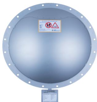
采用气动清洗系统和超高真空操作的过滤器装置需要一个能长期承受真空和正压循环的爆炸泄压设备。对于这样的要求, GE 无疑是最佳选择。其圆顶设计可耐负压, 而无需额外的真空支撑。GE 型泄压装置采用压力峰值阻尼和集成法兰垫片。
