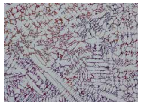
铸造黄铜经Klemm III腐蚀，10X。制备方法是根据SumMet方案，使用CarbiMet砂纸。
