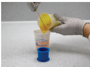
把混合液倒入第三个杯中，刮抹侧壁
