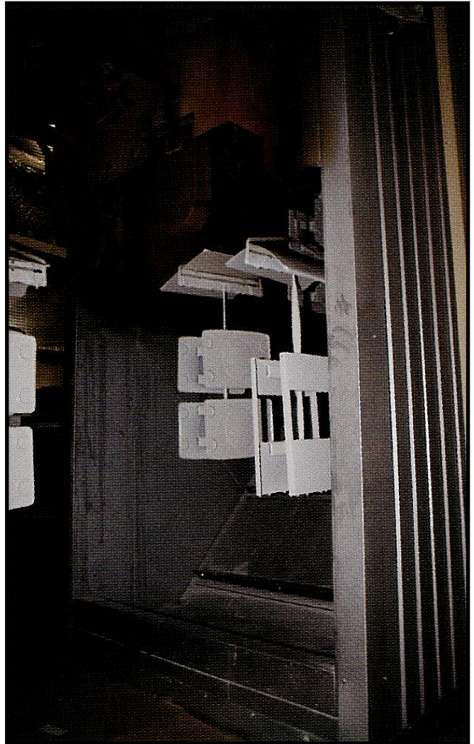
▲粉体塗装用焼き付け乾燥炉出入り口
