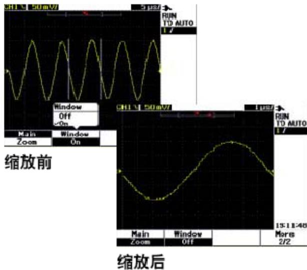
图 2 由于每条通道 125 kb 的深内存，可以使用放大功能，把信号放大到感兴趣的波形段，详细查看信号的细微细节。
