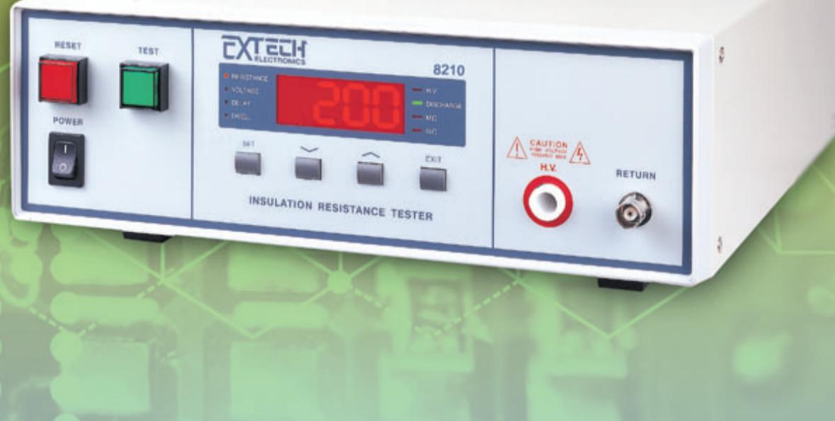
8210採用微控制器為主控制器的絕緣阻抗測試器，提供30-1000Vdc輸出及可量測0.1MΩ-200GΩ的阻抗範圍，大型的LED顯示器可顯示設定和測試值。數位式阻抗表，電壓表和計時器功能可提供使用者更多的測試數據。
