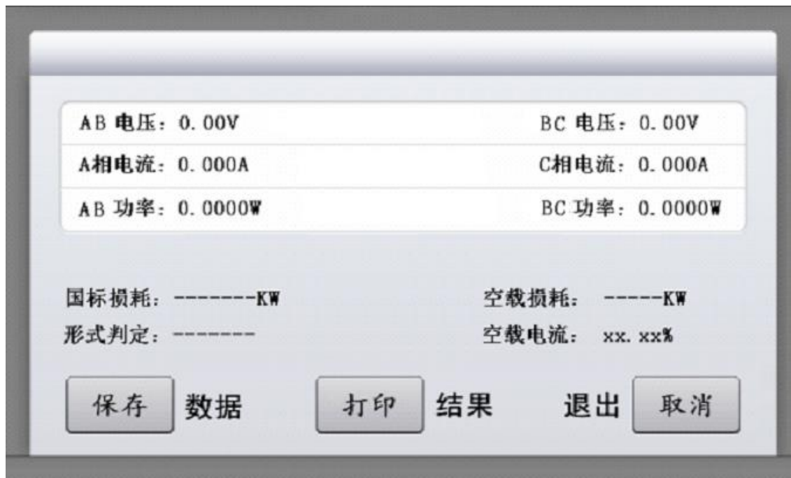
图七 两元件法空载测试
